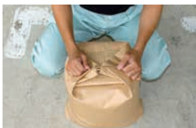
⑦ひもの根元で「真結び」にする。このとき「たて結び」にならないように注意する。
